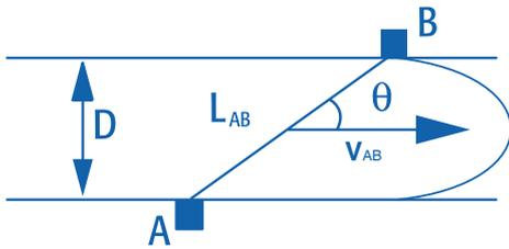
$$V_{AB} = \frac{L_{AB}}{2 \times \cos\theta} \times \frac{T_{BA} - T_{AB}}{T_{BA} \times T_{AB}}$$
